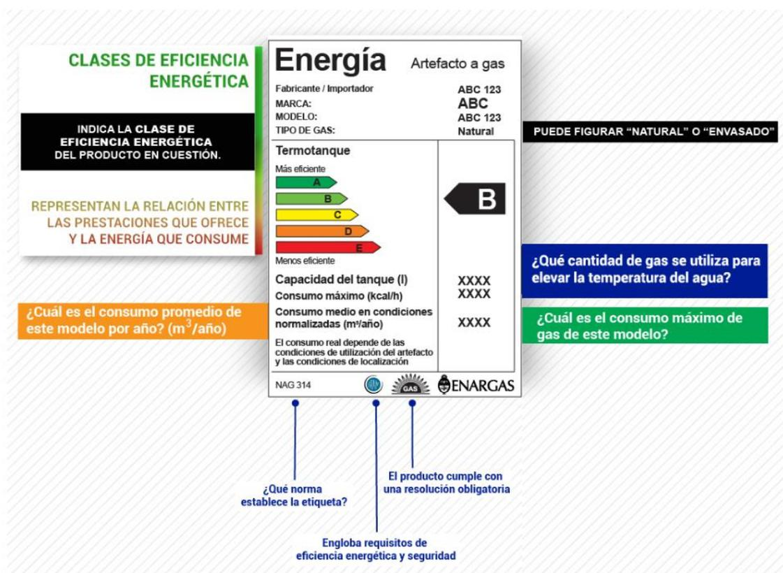
Esta etiqueta califica la eficiencia mediante un sistema comparativo que se compone de cinco clases de eficiencia identificadas como A, B, C, D y E donde la clasificación A se le adjudica a los termotanques a gas más eficientes y la E a los menos eficientes.
