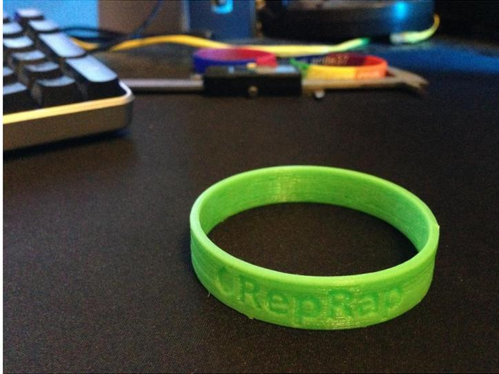
El **material flexible** es un **filamento curioso** en la impresión 3D, tiene unas características muy específicas que nos permiten realizar piezas impresas increíbles aunque tiene una **alta dificultad** a la hora **de la impresión**. El material flexible consiste en una combinación de plástico y caucho ofreciendo las mejores propiedades de cada elemento.
